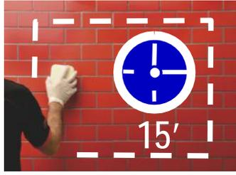
接缝处的水分停滞。这使产品能够更好地施工，延长了填缝剂在瓷砖表面上结皮的时间。
